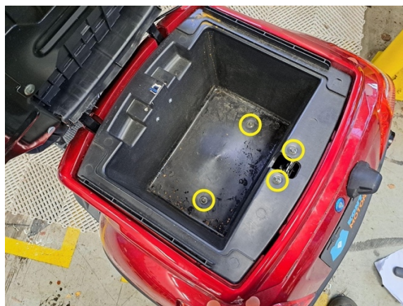
Irrota säilytyslokero kiinnityspultit. (hylsy 8 mm).
