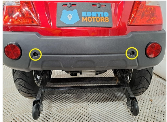
Irrota takakatteen kaksi kiinnityspulttia. (hylsy 8 mm).
