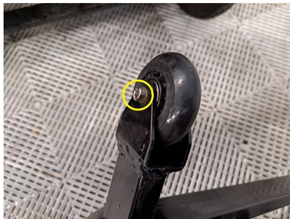
Irrota kippauksenesto tukipyörien kiinnityspultit, (kuusiokoloavain 5 mm) joilla on vastamutteri. (hylsy 10 mm).
