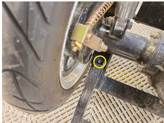
Irrota kippauksenesto rungon kiinnityspultit, (hylsy 10 mm) joilla on vastamutterit. (kiintoavain 12 mm).
